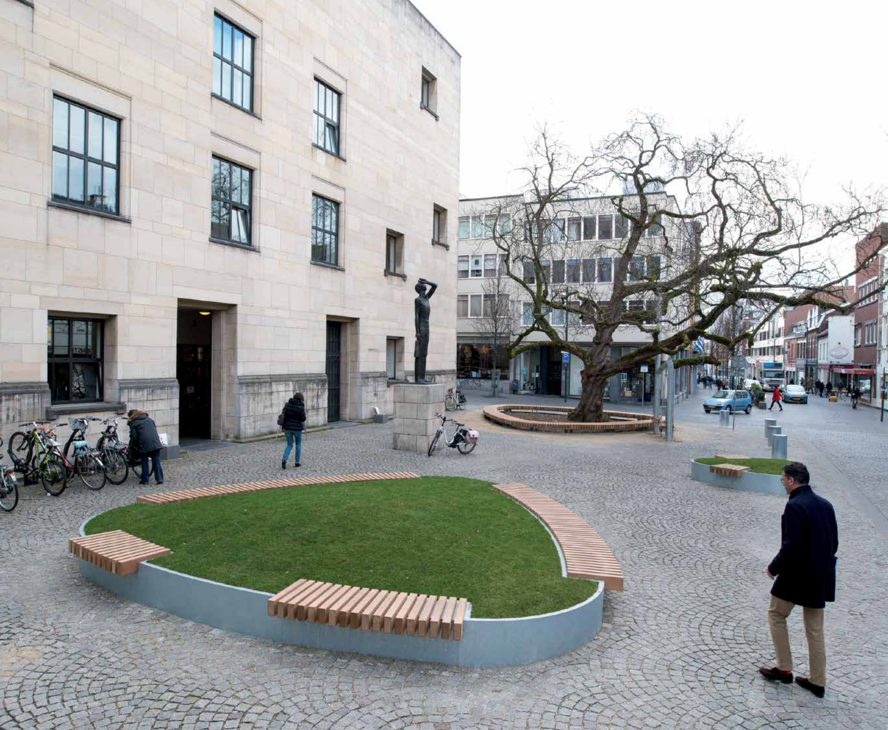
Für die Geleenstraat im niederländischen Heerlen wurde ein Komplettentwurf mit diversen, maßgefertigten Produkten umgesetzt. In diesem neuen Plan sind verzinkter Stahl und Holz die Basiselemente. Verzinkter Stahl wurde sowohl in den Inseln, einem maßgefertigten Baumgitter als auch in den Gestellen der Kreisbank verarbeitet.
